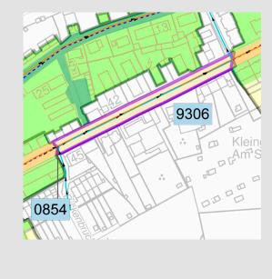
Das Einzugsgebiet der **Einleitungsstelle 914 000 9306** umfasst die Verkehrsfläche zwischen der Dickenbruchstraße zwischen Haus Nr. 43 und Haus Nr. 29. Die Verkehrsbelastung der Dickenbruchstraße im Bereich der Einleitung beträgt 2.000 Kraftfahrzeuge pro Tag. Gem. Trennerlass fallen die Flächen in die Kategorie IIb.
