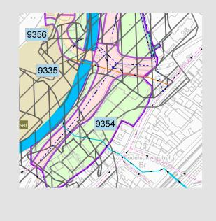
Das Einzugsgebiet der **Einleitungsstelle 914 000 9335** umfasst die Verkehrsfläche der Bahnhofshinterfahrung südlich der Villa Post. Die Verkehrsbelastung der Bahnhofshinterfahrung im Bereich der Einleitung beträgt 25.100 Kraftfahrzeuge pro Tag. Gem. Trennerlass fallen die Flächen in die Kategorie III.
