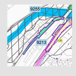
Das Einzugsgebiet der **Einleitungsstelle 914 000 9255** umfasst die Verkehrsfläche der Straße Am Volmewehr im Bereich der Bahnüberführung Die Verkehrsbelastung der Straße Am Volmewehr beträgt 1.250 Kraftfahrzeuge pro Tag. Gem. Trennerlass fallen die Flächen in die Kat. Ila.
