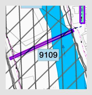
Das Einzugsgebiet der Einleitungsstelle 914 000 9109 umfasst die Verkehrsfläche der Fußgängerbrücke Im Klosterkamp. Die Brücke ist ausschließlich für Fußgänger und Radfahrer freigegeben. Die Verkehrsfläche der Fußgängerbrücke ist gem. Trennerlass der Kategorie I zuzuordnen.
