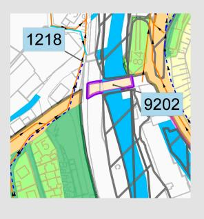
Das Einzugsgebiet der **Einleitungsstelle 914 000 9202** umfasst die Straßenentwässerung der Osemundstraße im Bereich der Brücke über die Volme. Die Verkehrsbelastung der Osemundstraße im Bereich der Einleitung beträgt 2.000 Kraftfahrzeuge pro Tag. Gem. Trennerlass fallen die Flächen in die Kategorie IIb.
