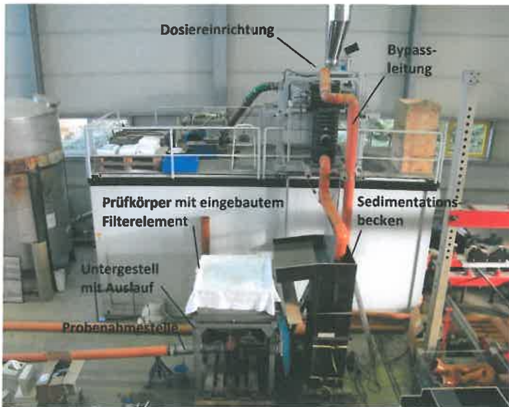
Abb. 2: Modell der NW-Behandlungsanlage angeschlossen an die IKT-Prüfanlage für Niederschlagswasserbehandlungsanlagen. (Bildquelle: Nady Rafail)
